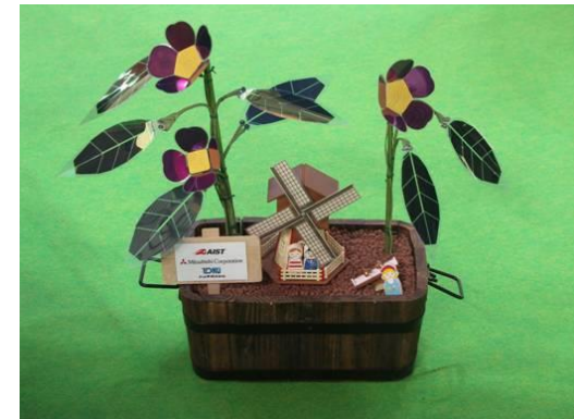
フタロシアニンを用いた緑色の葉っぱの形状をした太陽電池 (三菱商事、キャノントッキとの共同研究)
