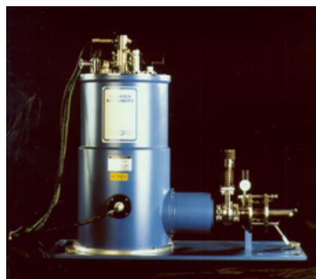
測光一次標準である NMIJ の極低温電力置換型絶対放射計
