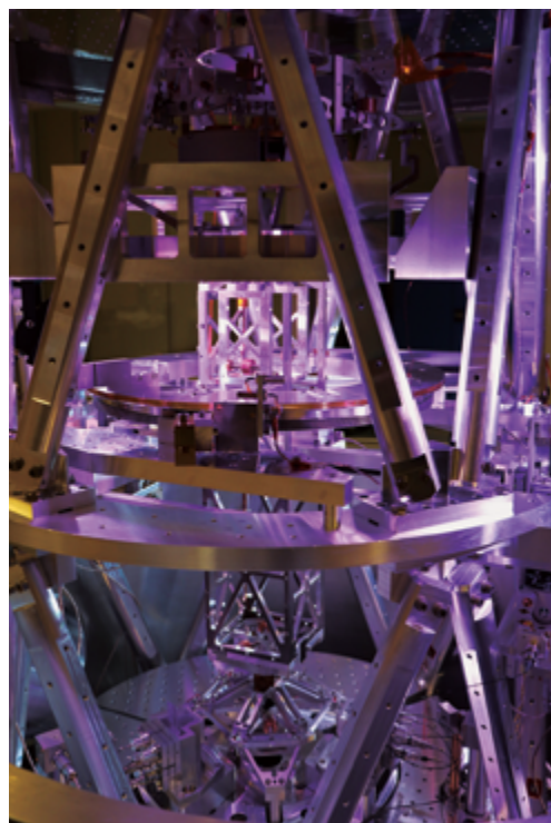
BIPM が開発中のキップル天びん 【出典】BIPM 提供（Photo courtesy of the BIPM）
