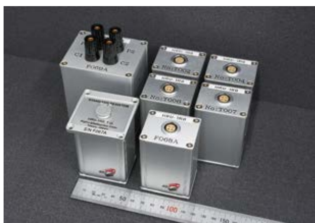
周波数依存性の評価のため NMIJ が企業と共同開発した、様々な内部構造等を有する 1 \Omega 標準抵抗器
