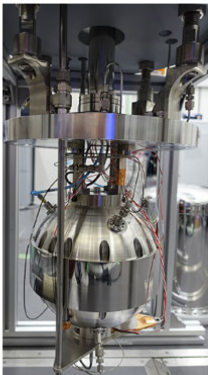
室温以上の高温域用として NMIJ/AIST で新たに開発された、熱力学温度を測定するための音響気体温度計の共鳴器
