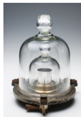
国際キログラム原器の複製の一つである日本国キログラム原器
