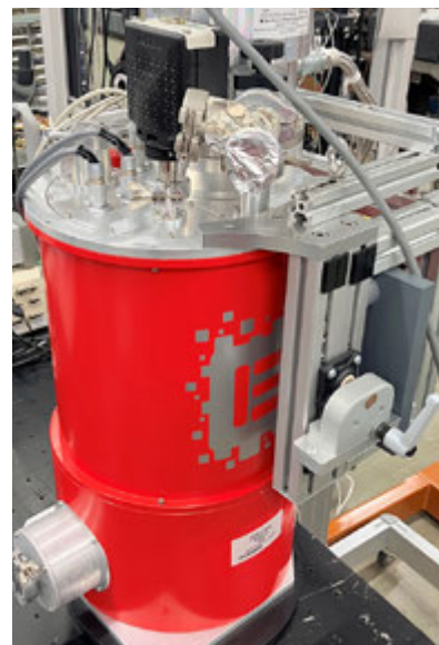
NMIJ が従来の液体ヘリウム溜め込み式に替えて導入を進めている、機械式冷凍機を用いた極低温電力置換型放射計
