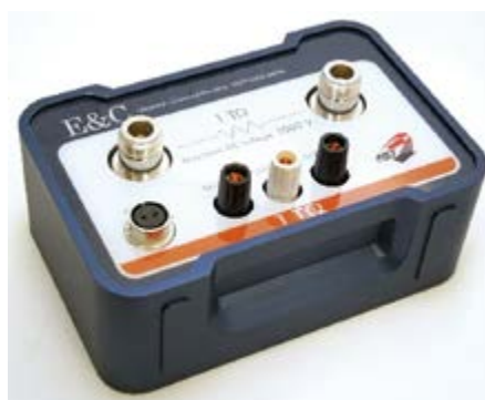
NMIJ が三菱ガス化学ネクスト株式会社と共同開発した高抵抗標準抵抗器
