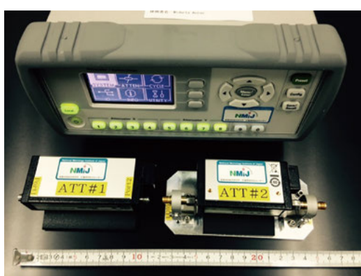
産総研 (NMIJ) が実施しているミリ波減衰量基幹国際比較 (CCEM.RF-K26) 仲介器一式 (左) と同等性結果の一例 (右)
