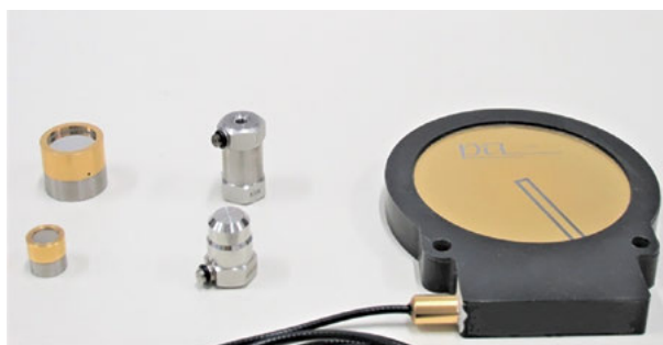
一次標準として用いられる NMIJ の変換器（左から標準マイクロホン、振動ピックアップ、ハイドロホン）
