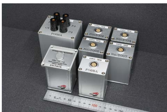
周波数依存性の評価のため NMIJ が企業と共同開発した、様々な内部構造等を有する 1 \Omega 標準抵抗器
