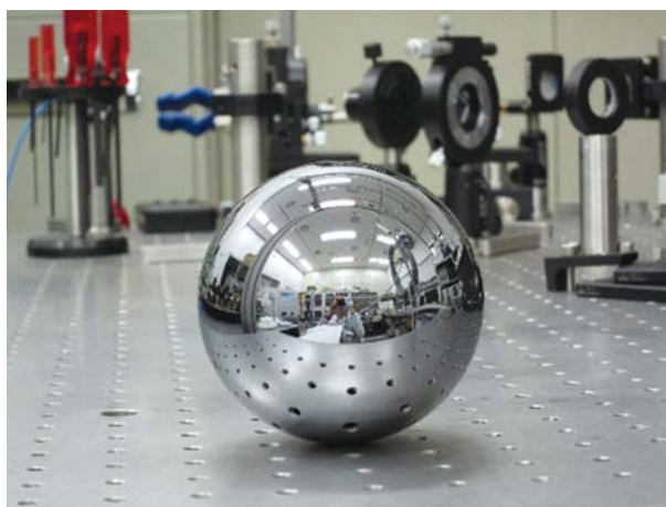
密度・粘度作業部会が実施する密度の国際比較で仲介器として使用される 1 kg シリコン単結晶球体
