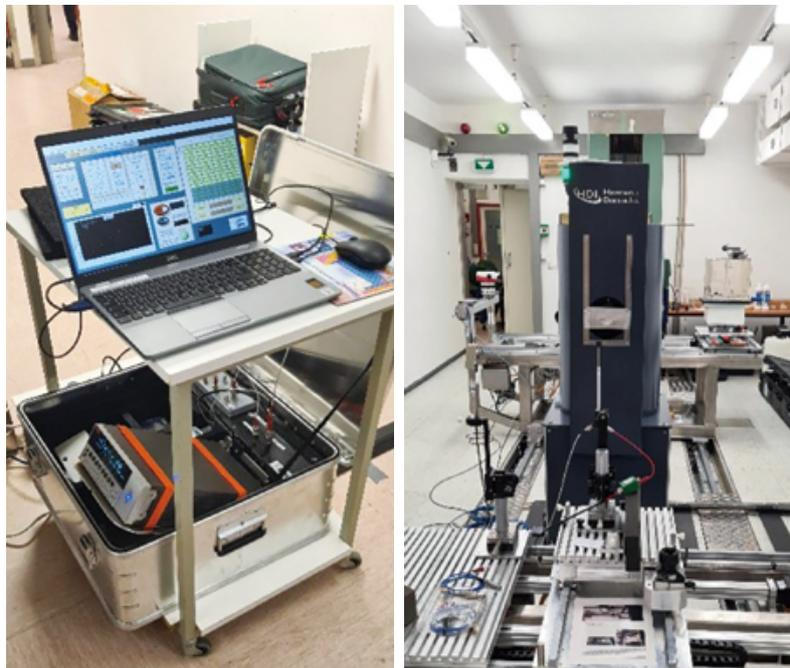
IAEA の Cs-137 照射施設 (右) を使用した BIPM.RI(I)-K5 基幹比較用に開発した測定システム (左)
