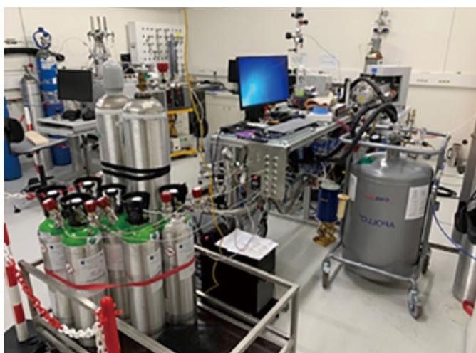
CO<sub>2</sub> ガス及び大気中 CO<sub>2</sub> 同位体標準製造のための同位体比質量分析設備
