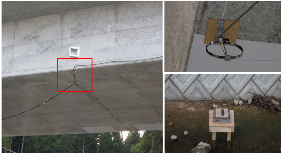
現行法のリング型変位計：高コストで時間がかかる
