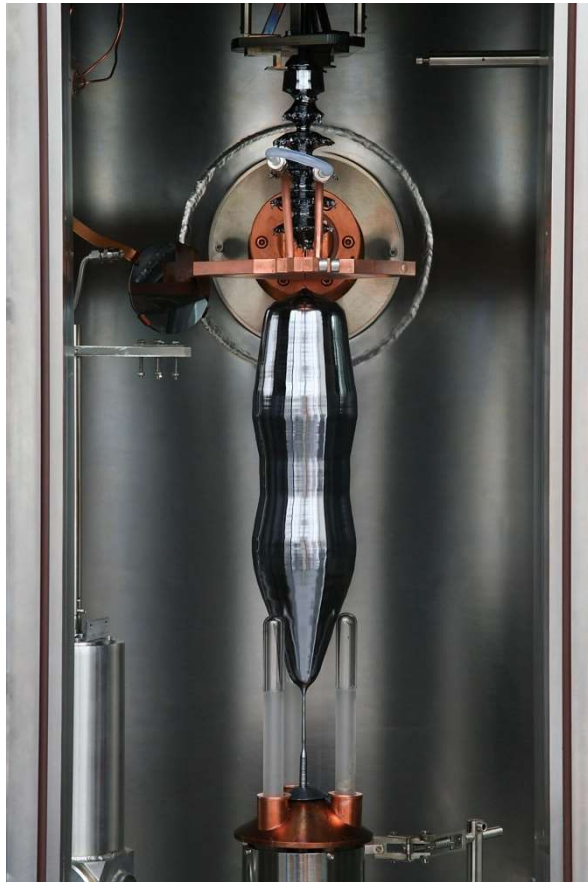
ドイツIKZで引き上げられた 28 Si同位体濃縮結晶Avo28 (FZ法、2007年5月)
