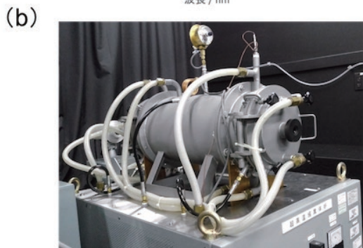
図 11 (a) 温度の異なる黒体からの分光放射輝度の比較、および (b) 高温黒体放射炉の外観
