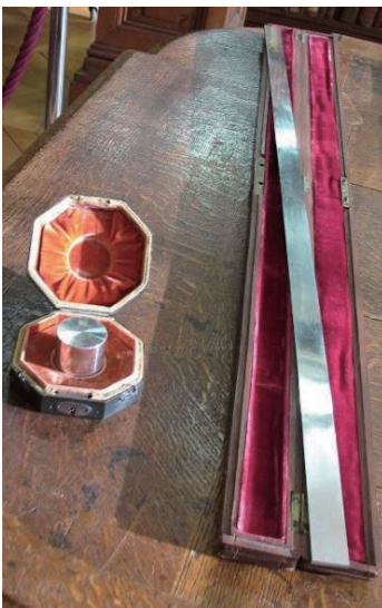
図 1 1799 年にフランスのメートル法で採用された確定キログラム原器 (左) と確定メートル原器 (右) : 何れも純粋な白金製。写真提供 : Terence J. Quinn 元 BIPM 局長
