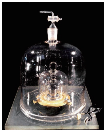
図 2 1889 年にメートル条約にもとづいて質量の単位の定義として採用された国際キログラム原器 : 直径、高さともに 39 mm の直円筒型。白金イリジウム合金製。写真提供 : BIPM
