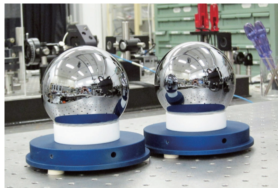
図3 1 kg ^{28}\text{Si} 単結晶球体：アボガドロ定数高精度測定のためにアボガドロ国際プロジェクトによって製作された。1個あたりの製造費用は約1億円である。
