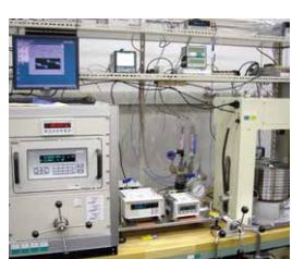
気体高圧力校正システム
