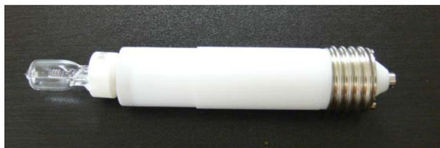
図 9. 分光全放射束標準電球。LED 照明等多様性に富んだ放射源の校正に役立つよう、分光分布、放射束、再現性等を勘案した慎重な選別や点灯条件最適化が実施された
