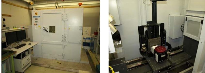
図4. 産総研で開発したDimensional X線CTの外観と内部の構造
