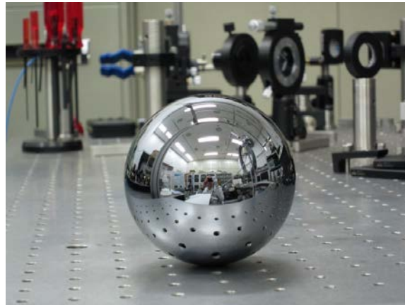
図1. 産総研がアボガドロ定数決定に用いた1kg単結晶シリコン球体 質量は1kg、直径は93.6mmであり、質量と体積の絶対測定によりその密度が決定された。 現在は我が国の密度の国家標準として使用されている。
