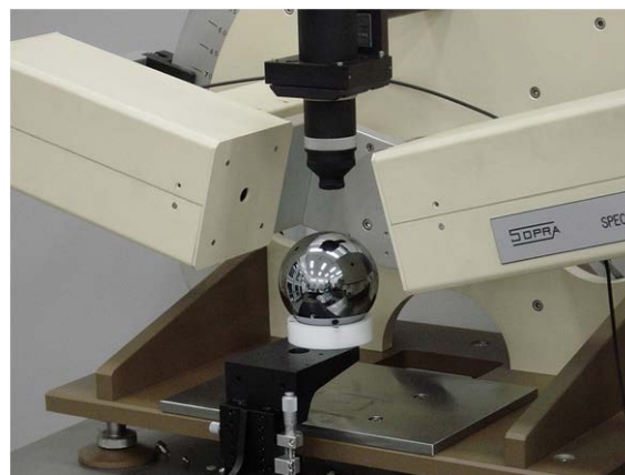
図4. ^{28}\text{Si} 同位体濃縮球体表面分析に用いた分光エリプソメーター X 線反射率法により値付けされた膜厚標準物質で校正することで、国家計量標準にトレーサブルな球体表面分析が可能である 21) 。
