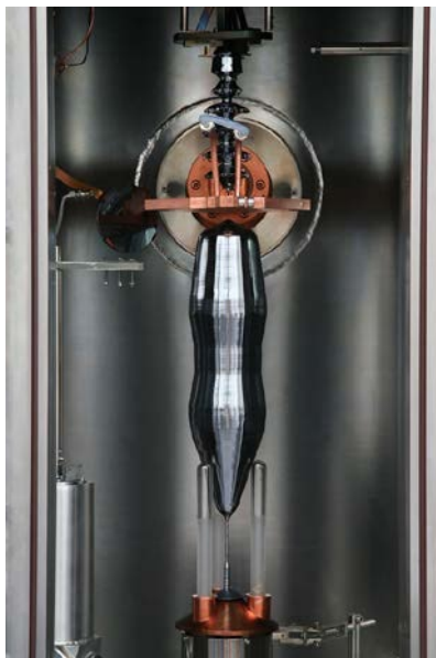
写真1. 浮遊帯域 (FZ) 法で引き上げられた同位体濃縮度99.99%、質量5kgの ^{28}\text{Si} 同位体濃縮単結晶 13,14) 。
