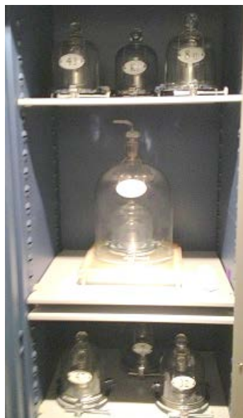
図2. 国際度量衡局に保管される国際キログラム原器 (中央の大きなガラスベルジャーの中にあるのが原器で、他は副原器。筆者撮影)
