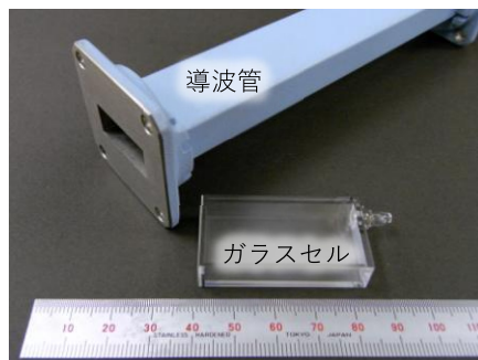
図2 導波管挿入用ガラスセル(左)とラビ周波数から測定した電磁波強度(右)
