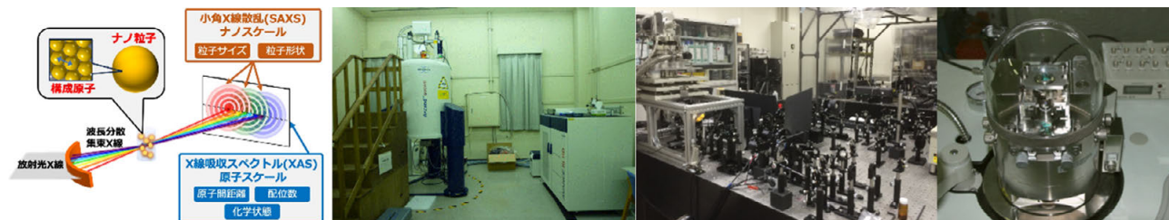
左から、小角 X 線散乱 X 線吸収スペクトルの同時高速測定概念図、固体 NMR 装置 (600 MHz)、フェムト秒過渡吸収分光装置、環境・電気測定対応走査プローブ顕微鏡
