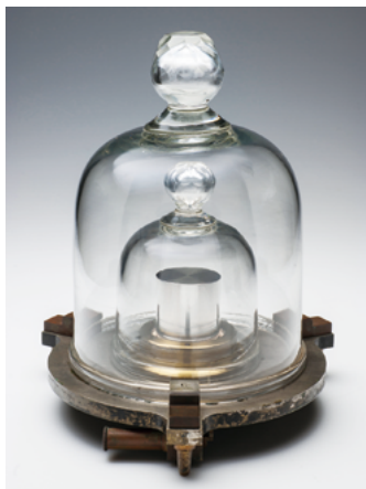
明治、大正、昭和、平成、令和の五つの時代にわたる約 130 年間、日本の質量の国家標準としての役割を担ったキログラム原器
