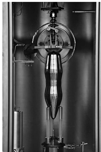
図4 ^{28}\text{Si} 同位体濃縮単結晶 34)
