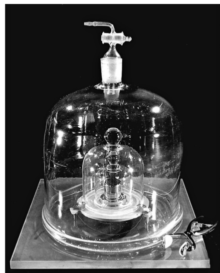
図 1 国際キログラム原器 (IPK) BIPM より
