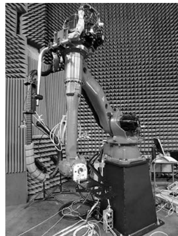
図 7 NIST の 6DOF ロボット CROMMA
