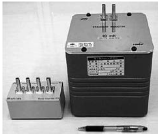
図 9 (左) キャパシタンス標準器 (1 μF) と (右) インダクタンス標準器 (10 mH) 24)
