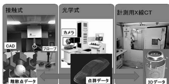
図 1 接触式 CMM, 非接触式 CMM, X 線 CT の比較 写真及びイメージ提供) 株式会社オプトン 12)
