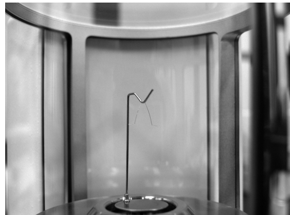
図 10 ウルトラマイクロ天秤に載せられた外国メーカー製の 0.1 mg 線状分銅
