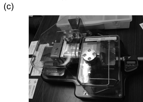
図10 TE_{01n} Split Cylinder 空洞共振器法の (a) 装置の構造、(b) 試料に対する電界の向き、(c) 装置（アメリカ国立標準技術研究所（National Institute of Standards and Technology, NIST）所有）。
