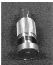
図9 同軸誘電体プローブ法のプローブの写真。写真下側の面を試料に接触させる（宮城県産業技術総合センター所有）。
