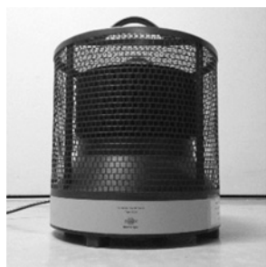
図 5.1 ファン型基準音源 Reference Sound Source Type 4204 (Brüel & Kjaer) φ 300 mm × 300 mm
