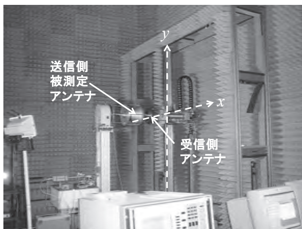
図13. 米国NISTにおける平面走査型アンテナパターン校正装置
