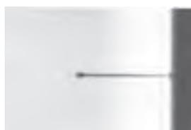
Fig. 12 インクジェットヘッドにおける液滴の吐出<sup>41)</sup>
