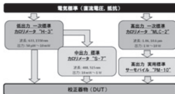
図2 NMIJレーザーパワー標準の構成
