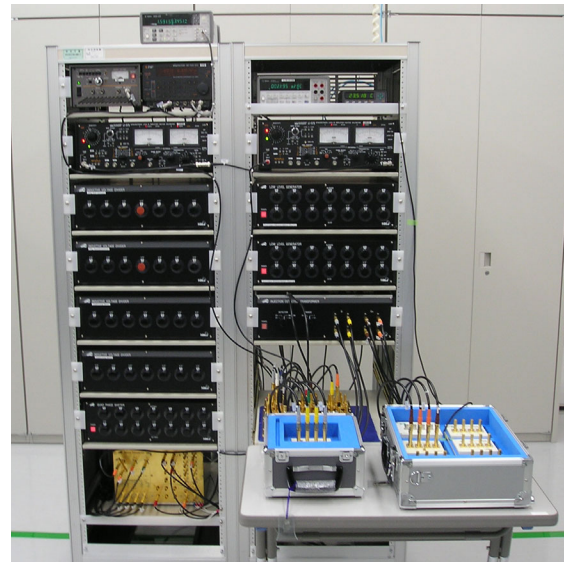
図3 NMIJで製作した四端子対インピーダンスブリッジの外観.
