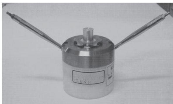
図1 音圧校正に使用する音響カプラ
