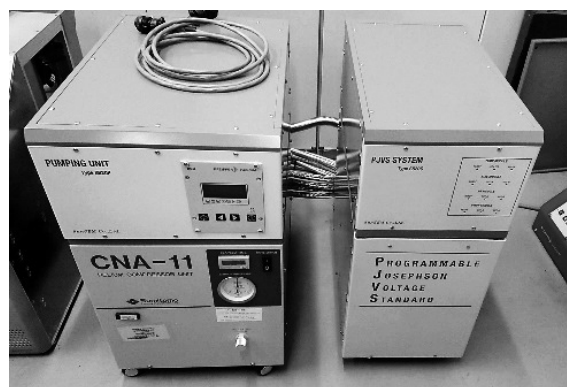
図15 微小電圧レンジのトレーサビリティを確保する二次標準器として開発された小型プログラマブル型ジョセフソン電圧標準（タワー型PJVS）装置のプロトタイプ
