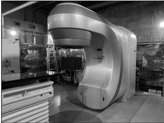
図2. 産総研の高エネルギー光子線および電子線の水吸収線量の標準場である医療用リニアック装置 (VitalBeam, Varian).
