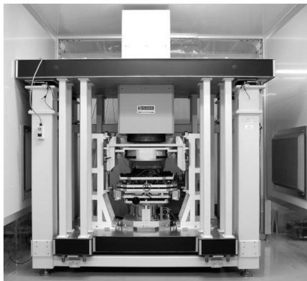
図2 AIST/NMIJ の超高精度大口径平面度干渉計
