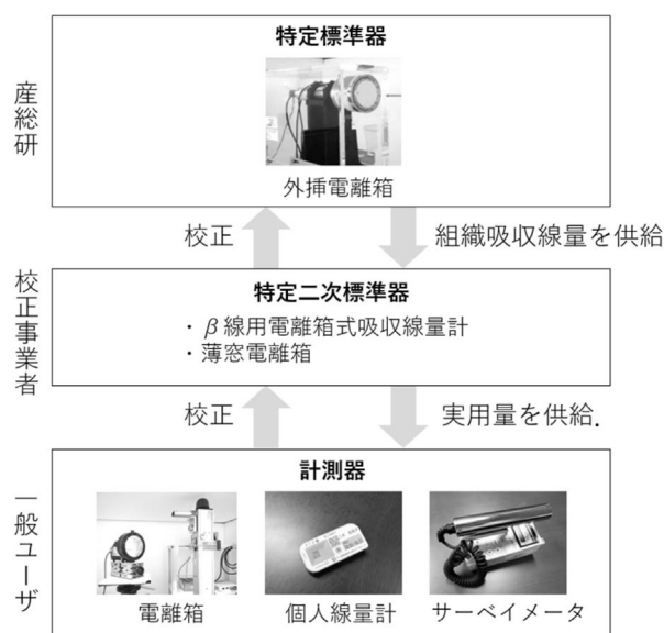
図2 現行のβ線のトレーサビリティ体系。現在、特定二次標準器としてはβ線用電離箱式吸収線量計が用いられている。
