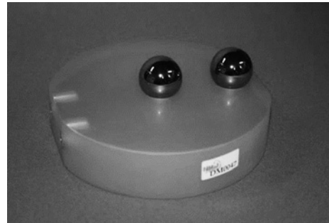
図6 単純形体を組み合わせたゲージ (NMIJ, 歯車基準器) 21)
