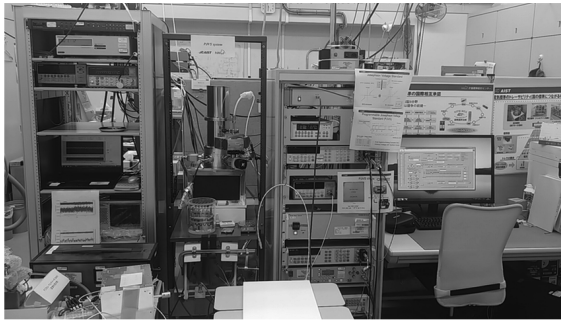
図5 現在の直流電圧標準システムの外観。
