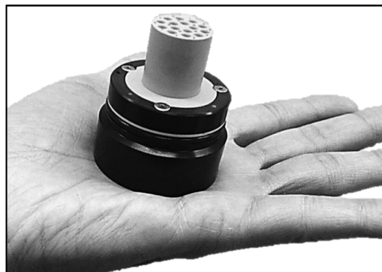
図7 測定原理に振動弦法を採用した、現場測定に向けて開発された粘度センサー (Mishra et al. (2014) 17) より、一部修正)
