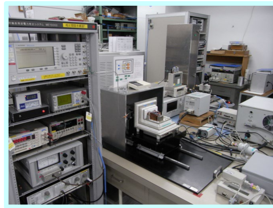
同軸2.9 mm (10 MHz ~ 40 GHz) 不確かさ : 0.6 % - 2.4 %
