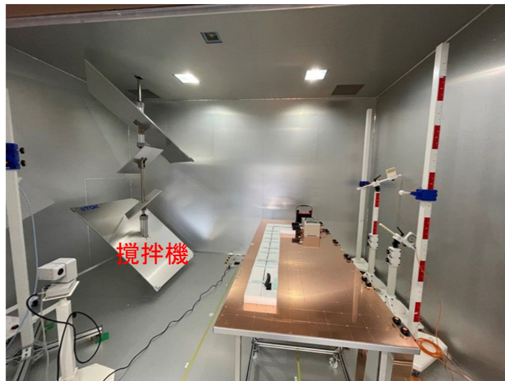
JQA安全電磁センター(東京都八王子市)の リバブレーションチャンバー
