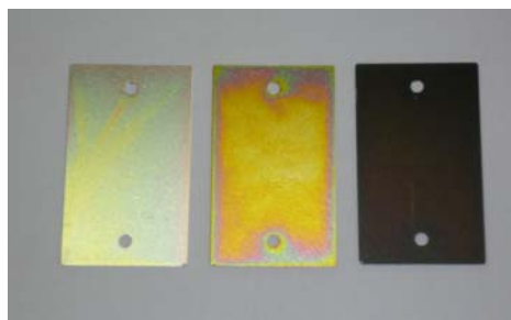
図3 第1回共同測定(平成 20 年度)の試験片。左から、3価クロメート(白)、6価クロメート(有色)、6価クロメート(黒)。サイズは、3.0 cm×5.0 cm である。板に空いている小さな孔(直径 2 mm)に細い銀線を通して抽出液中に吊る
