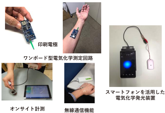
図1 小型軽量ウェアラブル無線機能を有する電気化学計測装置
