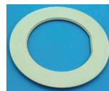
MgO開孔部材による実形状部品例
