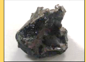
発生したクリンカ
