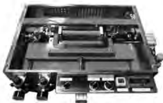
応力負荷型単板磁気試験器 【高精度磁気特性測定】
