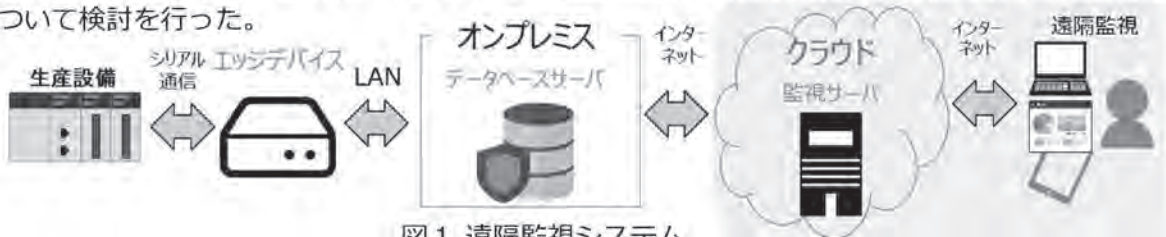
図1 遠隔監視システム
