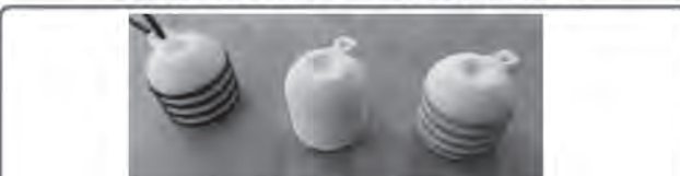
3Dプリンターを利用した鋳物の原型製作
