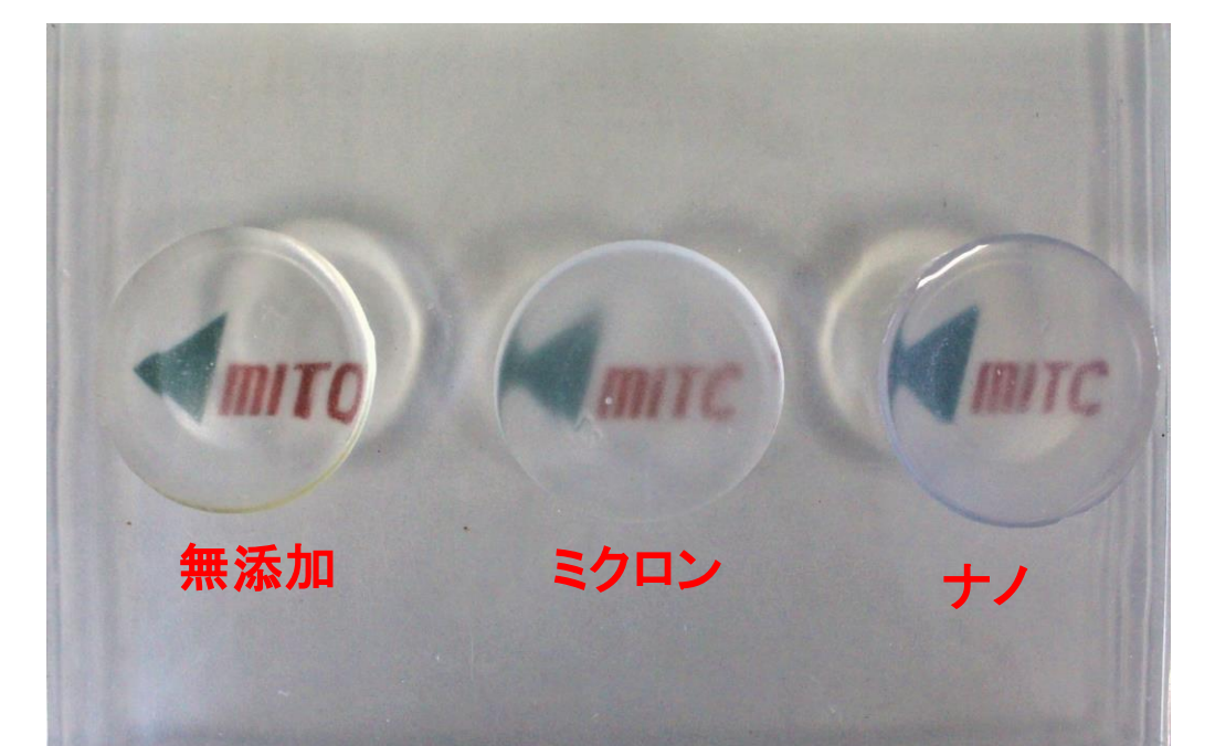
Fig.6 10%基板ガラスフィラー添加複合材料
