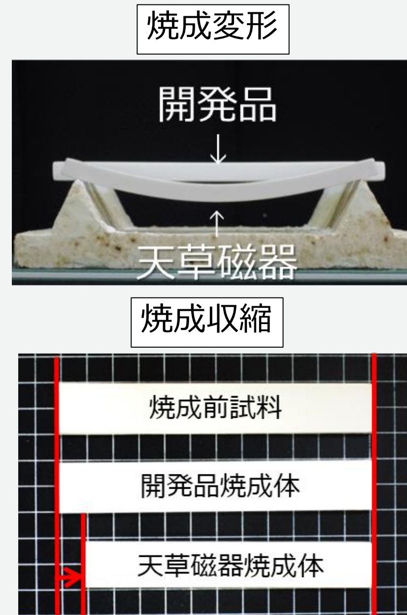
焼成変形、収縮がほとんどない、細孔直径の揃った連続気孔を持つ多孔質材料
