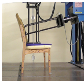
写真 背もたれの静的強度試験の様子
