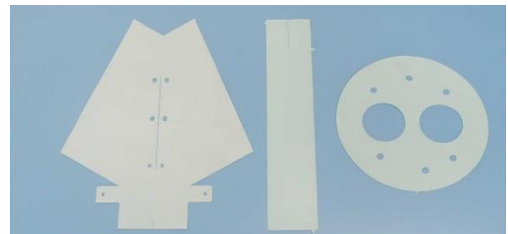
エアバッグ用シートの切断例
