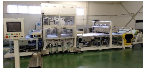
エアバッグ用シートのレーザー裁断装置
