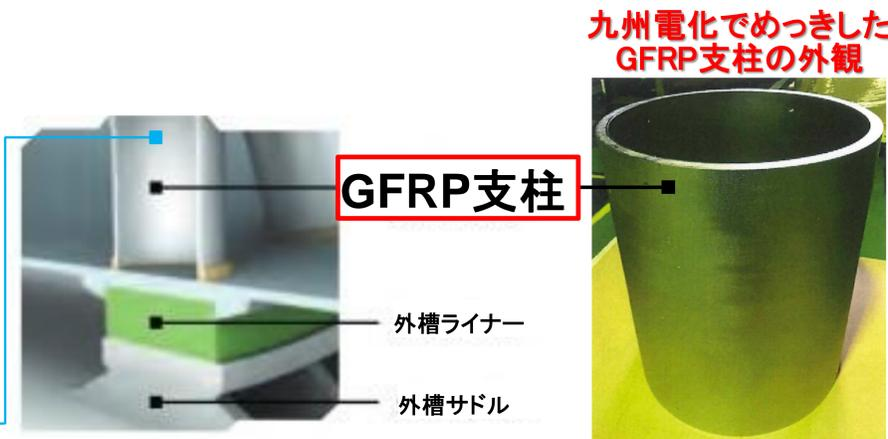
図3 水素運搬船の模式図とGFRPめっき支柱の外観
